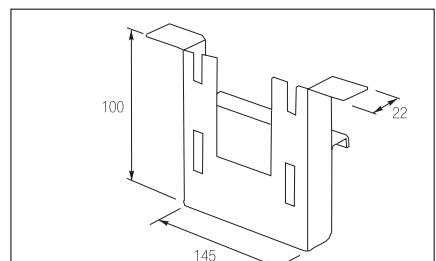
**TP** - CZ T-profil umožňuje vytvoření stolové konstrukce tvaru T
