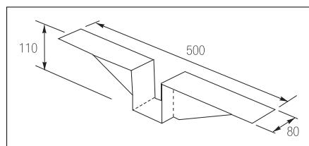
**ZP** - CZ zpevnovací profil mezi stolovou konstrukcí a deskou
